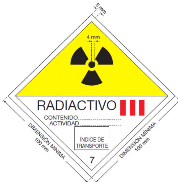
Figura A.4 Etiqueta para la categoría III-AMARILLA. El color de fondo de la mitad superior de la etiqueta será amarillo y el de la mitad inferior blanco, el trébol y los caracteres y líneas impresos serán negros y las barras que indican la categoría serán rojas.
